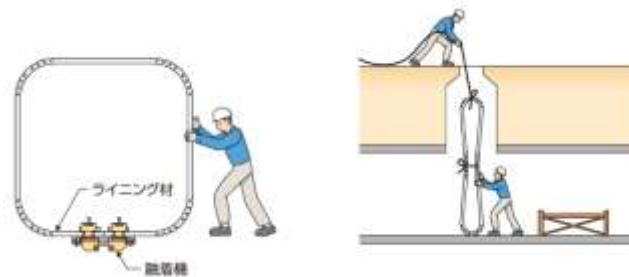
図-3 ライニング材の成形・管内搬入
