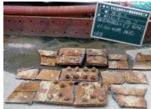
切羽で接断・回収された鋼材
