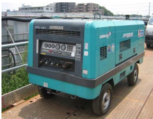
写真-解 2.1.1 エンジンコンプレッサー (100HP) の例
