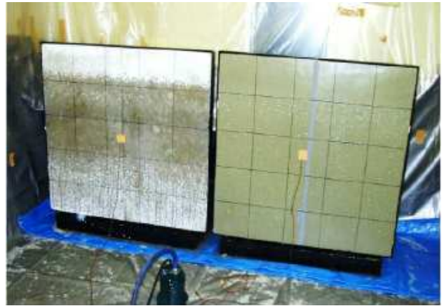
写真3 ミゼロン塗装面の着氷試験 (写真左がコンクリート面 写真右が塗装面)
